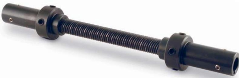
I giunti flessibili sono dispositivi meccanici che vengono utilizzati per accoppiare due assi o alberi rotanti non perfettamente allineati, mantenendo la massima precisione nella trasmissione. Il montaggio è estremamente semplice con serraggio a morsetto e non necessita di alcun supporto.
